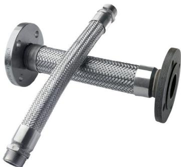
Construcción: Tubo flexible, reforzado con trenza de Inox. Casquillos de acoplamiento mecanizados y unidos por soldadura de inox.
